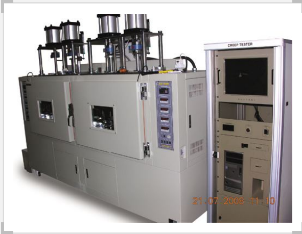
4연식 크립 시험기 4TYPE CREEP TESTER
